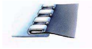
Detalle engatillado tipo LOC-4
