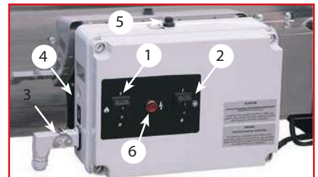
Leyenda, cuadro eléctrico (IP 65) para GA/N 80 C- GA/N 100 C y GA 100 C 1. Interruptor del quemador 2. Interruptor del ventilador 3. Toma y clavija para termostato ambiente 4. Pulsador de reset con luminoso de bloqueo (rojo), funcionamiento (verde) y stand-by (naranja) 5. Termostato de sobrecalentamiento de rearme manual. 6. Luminoso de presencia de tensión. Interruptores de mando con dos posiciones: Int. 1 OFF + Int. 2 ON = solo ventilación Int. 1 ON + Int. 2 OFF = quemador encendido con post ventilación para enfriamiento de la cámara de combustión Int. 1 ON + Int. 2 ON = quemador encendido con ventilación continua.
